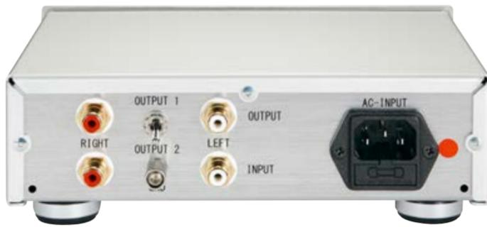
Die „EQ Unit“ bietet zwei Output-Modi, wobei subsonische Störungen gefiltert werden. Die auf einer Platine versammelte, im Ausgang diskret aufgebaute Elektronik wird aus einem streufeldarmen R-Core-Trafo (r.) gespeist. Die Netzphase gehört – wie mit dem roten Punkt markiert – nach rechts.
