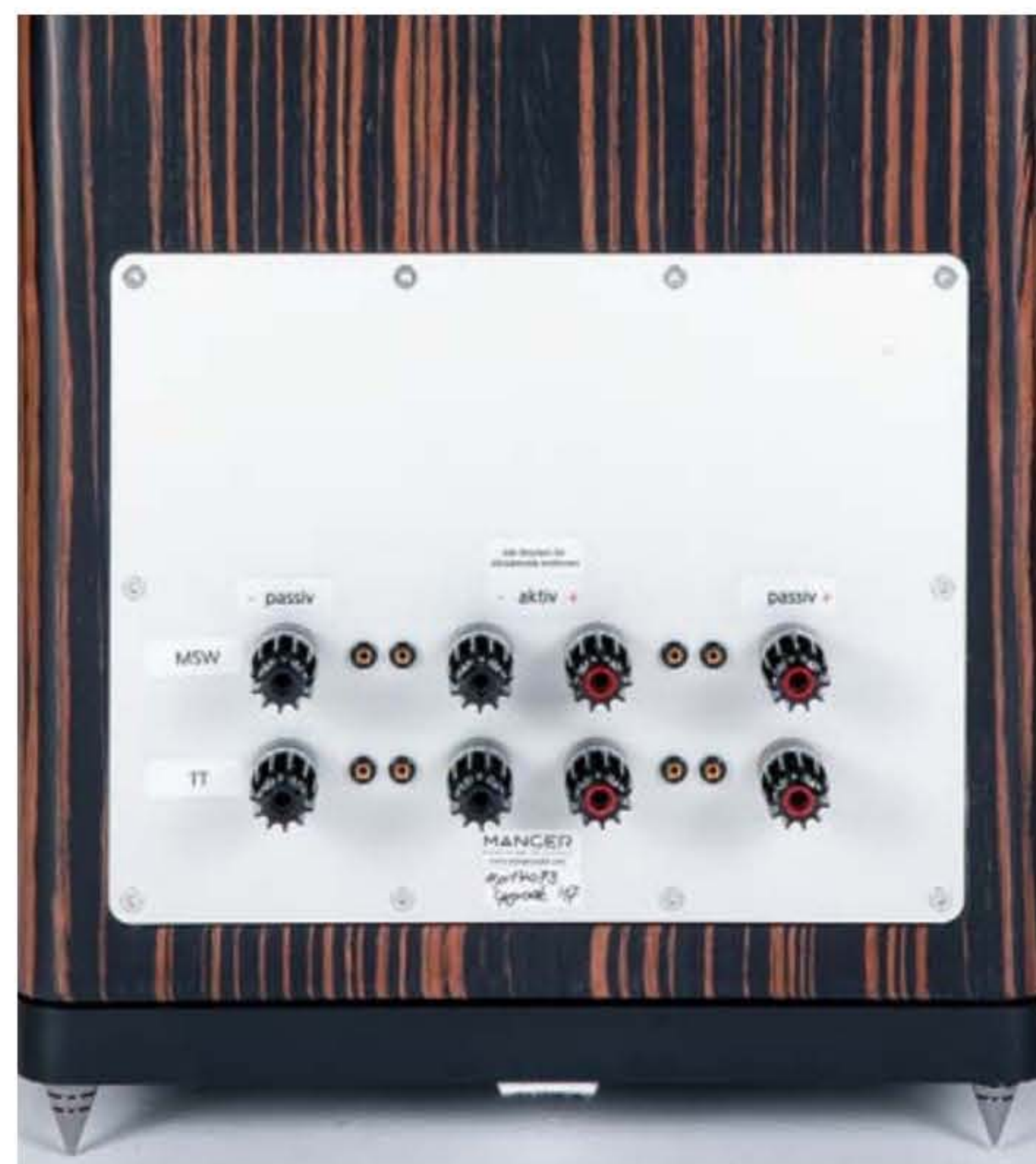
In der Mitte wird's aktiv: Die Spezialversion der Manger für wahlweisen Aktiv- oder Passiv-Betrieb
