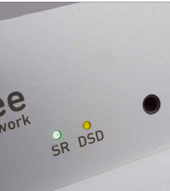
Die LEDs geben Aufschluss über die genutzte Abtastrate und den DSD-Modus
