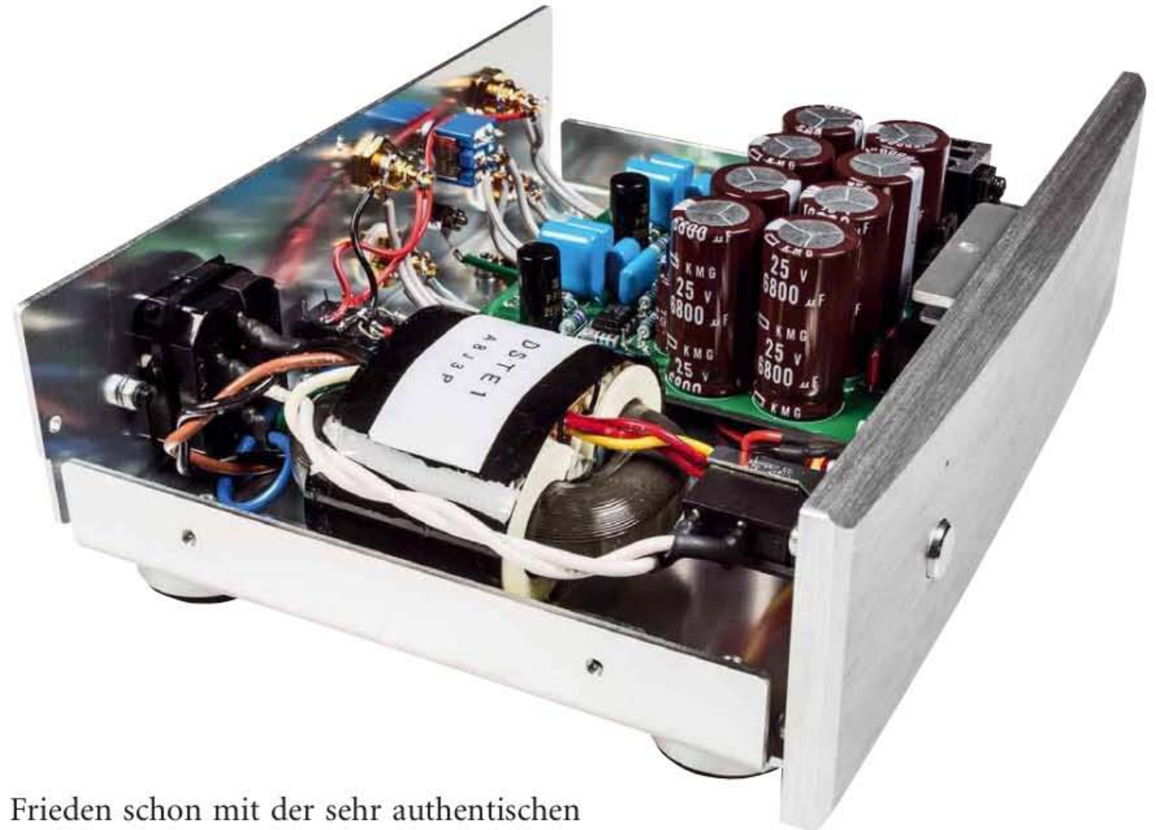
DS Audio spendierte dem Steuergerät ein ziemlich luxuriöses Netzteil
