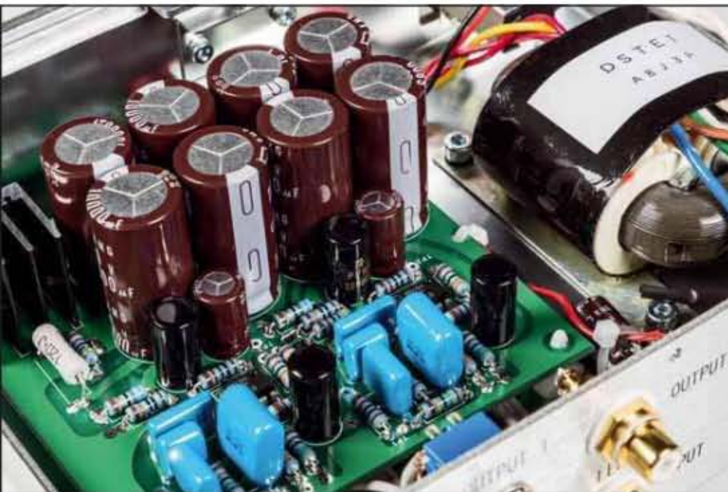
Die Verstärkerelektronik selbst kommt mit einem Operationsverstärker pro Kanal aus
