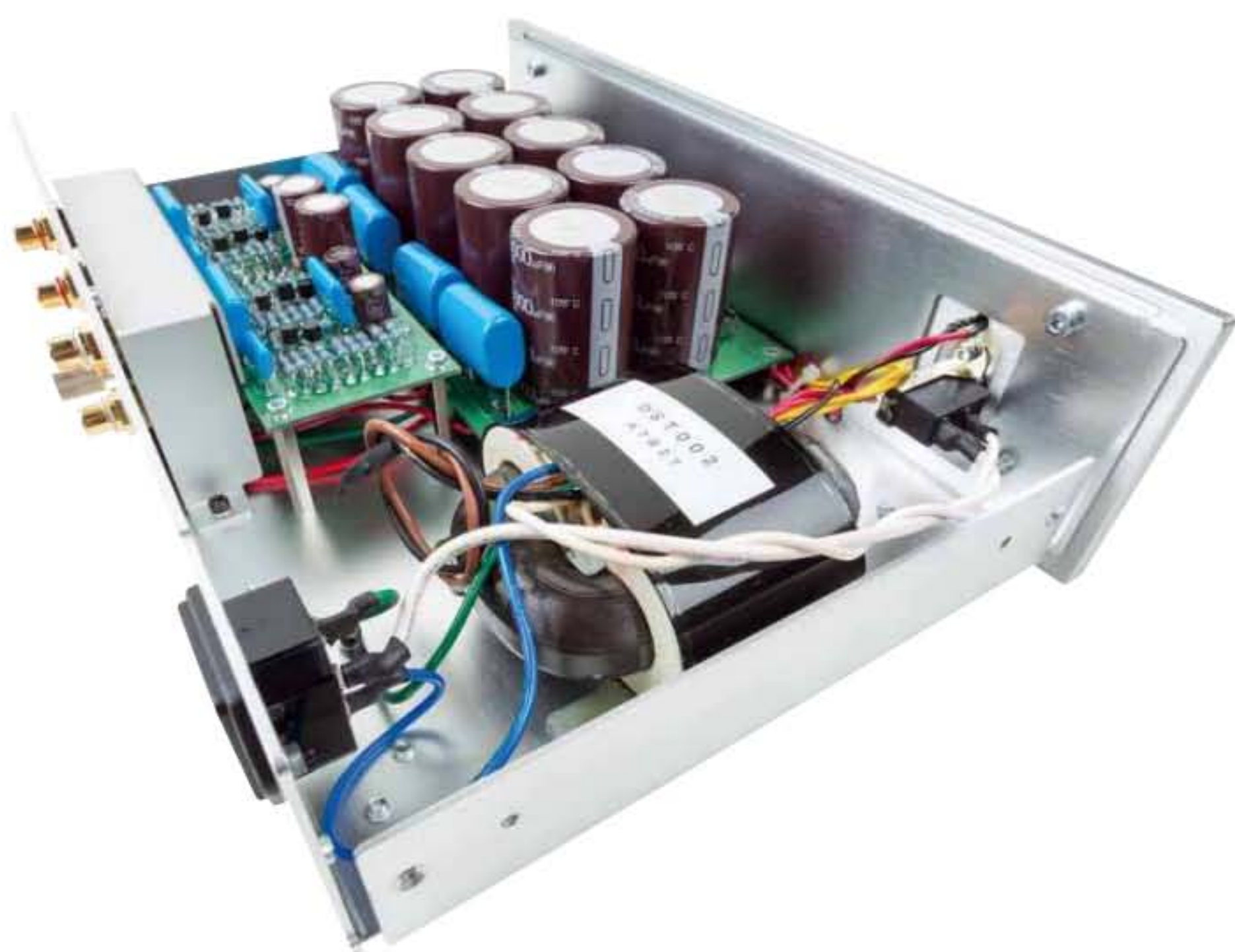
Der hochwertige R-Core-Trafo steckt normalerweise unter einem schirmenden Blech
