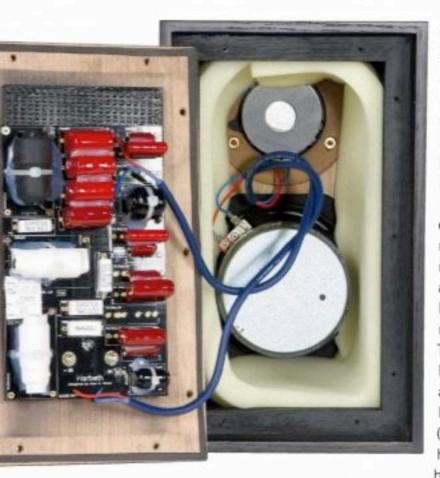
VOLL VERKLEIDET: Das nur fünf Liter netto messende Volumen wurde großzügig bedämpft, die Frequenzweiche filtert sanft, ist aber hochwertig bestückt.
